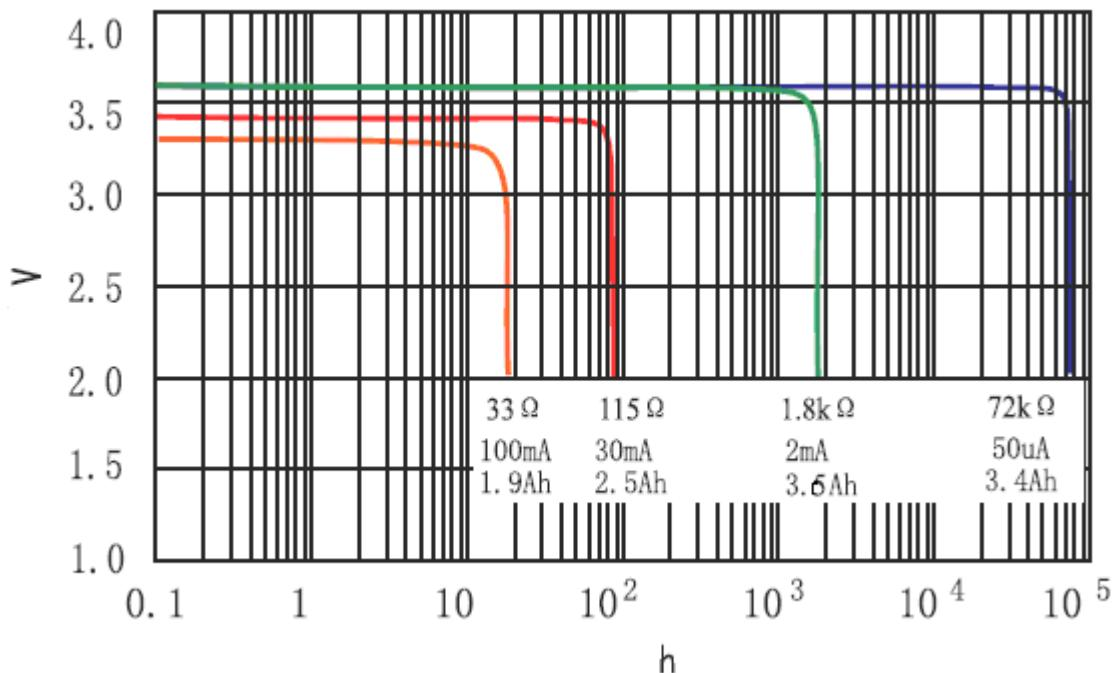
**Зависимость напряжения на элементе питания от температуры элемента питания и тока разряда:**
