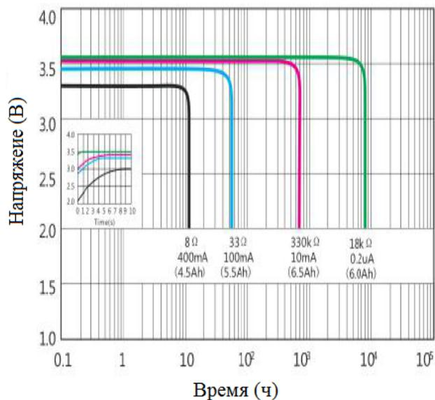
**Зависимость напряжения на элементе питания от температуры элемента питания и тока разряда:**
