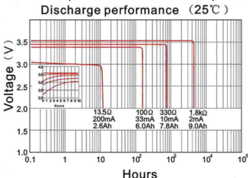
Зависимость напряжения на элементе питания от температуры элемента питания и тока разряда:
