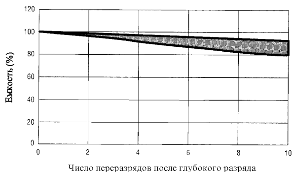
Рисунок 14 – Зависимость между числом перезарядов и действительной емкостью батарей (в процентах от номинальной)
