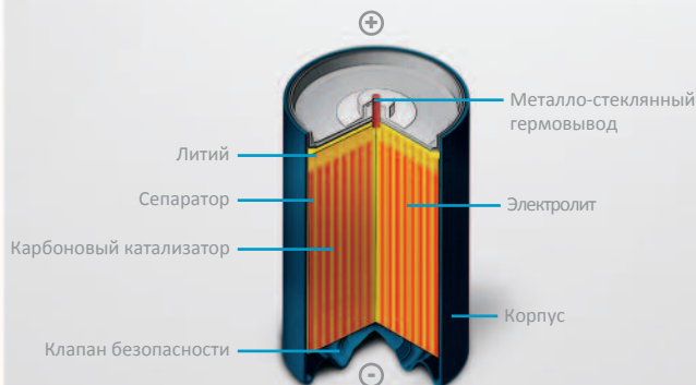
Элемент ролонной конструкции (серия LSH, LM, M, LO, G)
