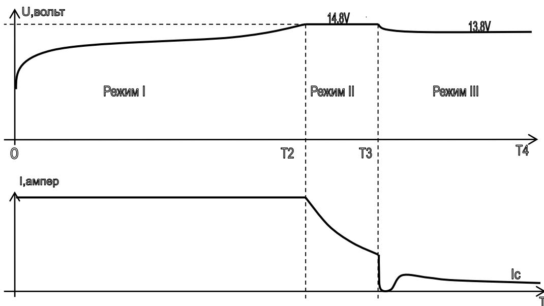
Режим I - режим объемного заряда (заряд аккумулятора непрерывным током).
