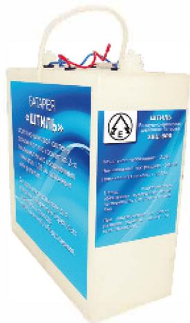
Батарея резервного типа состоит из двух последовательно соединенных элементов напряжением 1,2 В со щелочным электролитом. Предназначена для питания аппаратуры береговых светящихся средств навигационного оборудования.
