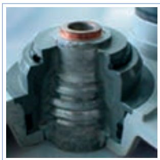
Рис. 7 Запатентованный полюс Sonnenschein
