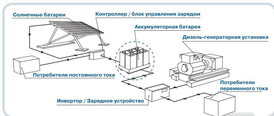
Типовая схема энергетической установки с использованием энергии солнца и ветра состоит из фотоэлектрической панели, вырабатывающей электричество постоянного тока при освещении солнечным светом, блока управления напряжением и током панели, аккумуляторной батареи, системы управления режимом заряда батареи, DC-AC конвертора, преобразующего постоянное напряжение в переменное для питания потребителей переменного тока. Система может быть дополнена ветрогенератором с его системой
